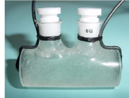
Bild 2-33: Messküvette: Paraffin im Inneren noch dickflüssig
