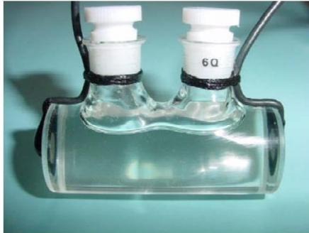
Bild 2-24: Messküvette mit flüssigem Paraffin
